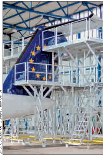
Das Wartungsdock für die sichere und effiziente Instandhaltung schmiegt sich sanft an das Flugzeug an, so dass die Hülle nicht beschädigt wird.
