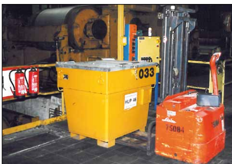
mobile Öl-Versorgung von Maschinen
