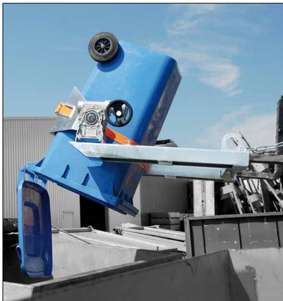
Typ FLEX-HK, Entleerung 240-l-Müllbehälter
