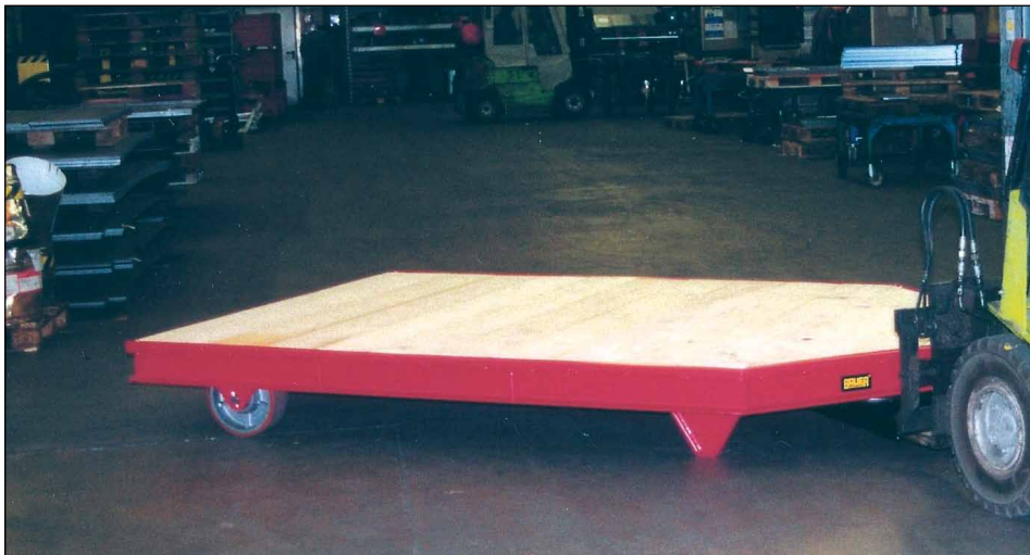
Mit den Gabelzinken in die Einfahrtaschen fahren, anheben und das STS ist betriebsbereit
