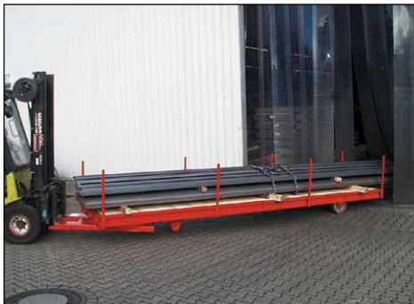
Transport von Langgütern; kleiner Wendekreis durch Direktaufnahme
