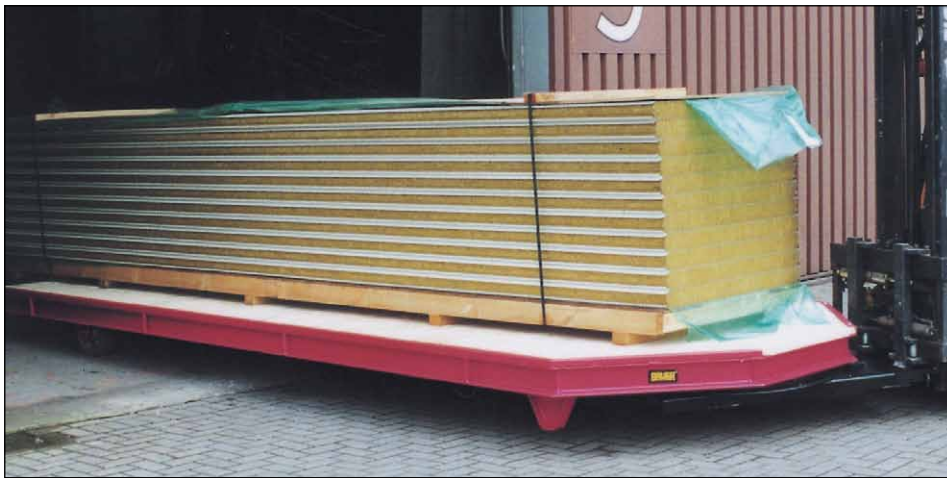
Transport von Langgütern; kleiner Wendekreis durch Direktaufnahme
