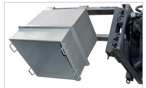
UC-Entleerung mit Stapler-Drehgerät
