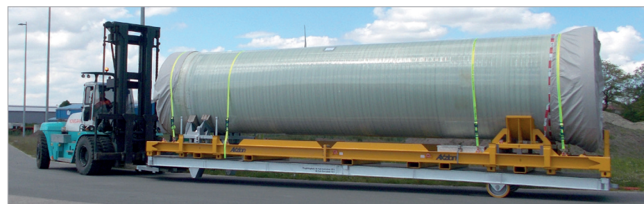
Pour le transport de pièces très lourdes et encombrantes: longueur 12 m, charge admissible 20 t
